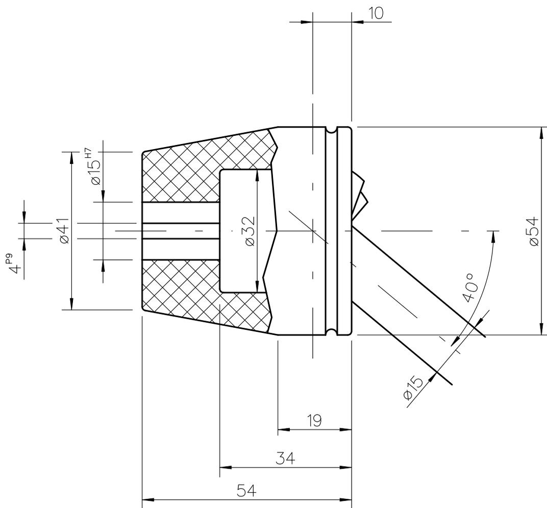
Gleichlaufgelenkwelle aus POM
